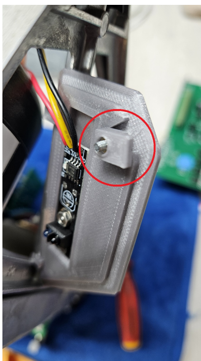
Foto 4 - Sensore di rotazione del motore sinistro (L) installato.
