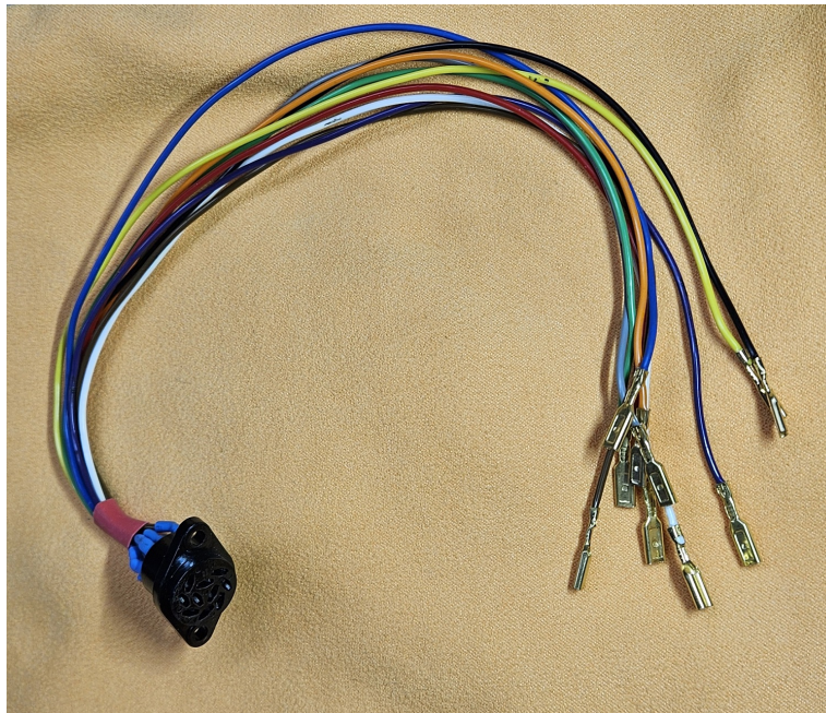
Photo 1 - Faisceau de la prise de télécommande externe : ces fils ne sont plus utilisés.
