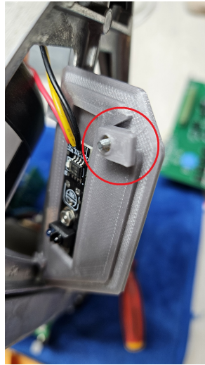
Foto 3 - Befestigungsteil: so ausrichten, dass es korrekt am Chassis anliegt.
