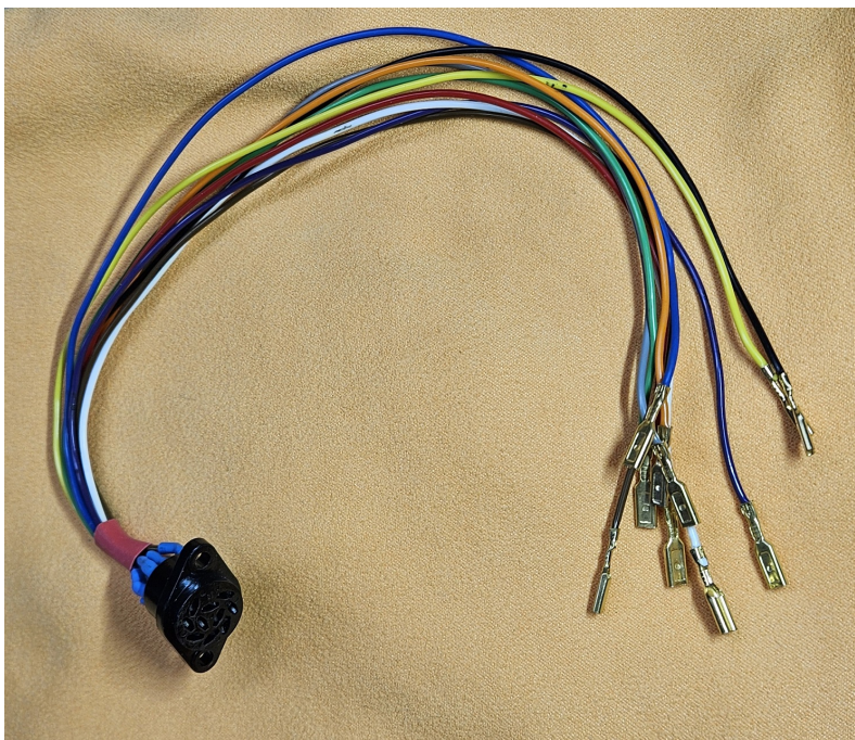
Foto 1 - Cablaggio della presa esterna del telecomando: questi fili non vengono più utilizzati.
